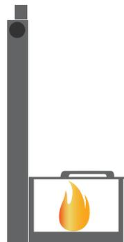
*Refermez la plaque foyer. Le Backfire fonctionne en feu continu. Fermez le clapet de l'avaloir. La fumée s'échappe par le conduit arrière. Cela évite toutes les déperditions calorifiques dans le conduit.*
